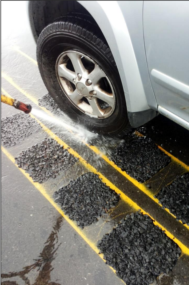
Mynd 2.8 Dekki snúið til hægri og vinstri á hverjum reit og spúlað
